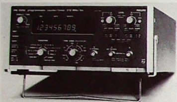
Voll programmierbarer Universalzähler „PM 6650“ mit Fernsteuerung für Frequenz- und Zeitmessungen (Philips)
