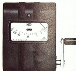
„Isognom 0413“ zum Messen von Isolationswiderständen (Gossen)
